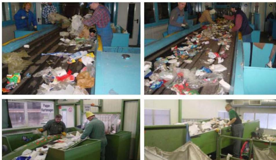
**Ilustración 2-2 Ejemplos de Sistema de Clasificación Manual de Residuos.**
