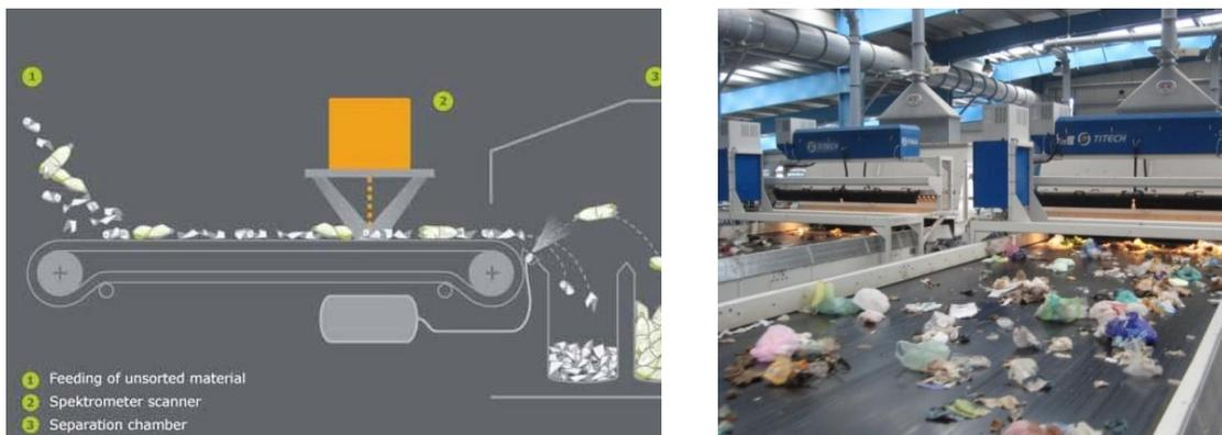
**Ilustración 2-5 Separación Automática de RSU Mixtos, Embalajes u Otros Excedentes**
