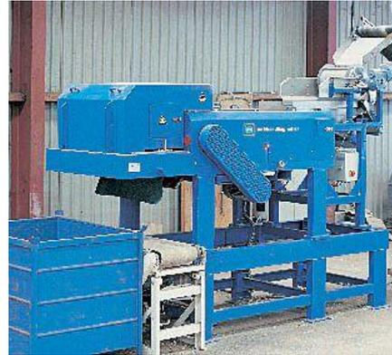
**Ilustración 2-2 Funcionamiento de un Separador de Corriente Foucault (“Eddy-Current”)**
