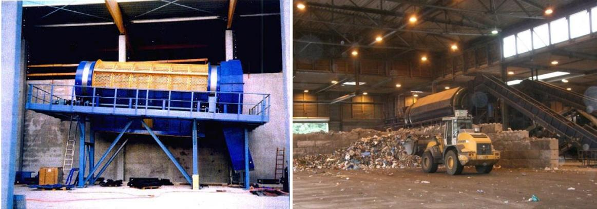
a) Instalación de un tamiz rotatorio (“trommel”) en una planta de clasificación de residuos comerciales.
