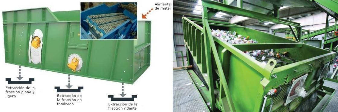
**Ilustración 2-3 Ejemplo de un Sistema de Separación Balística de Reciclables**
